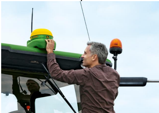
Рисунок 15.5 – Установка приемника StarFire 3000
